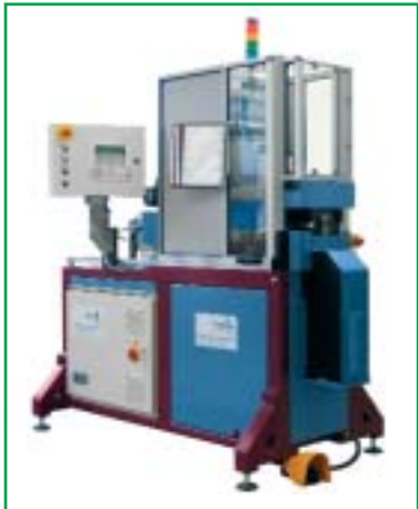
Auch als RU8-DT (Double Tool) bestellbar. Mit 6 oder 8 Doppelwerkzeugen (12/16)
